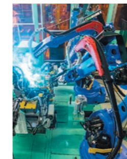
自動溶接設備
