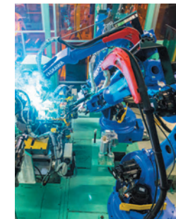
自動溶接設備
