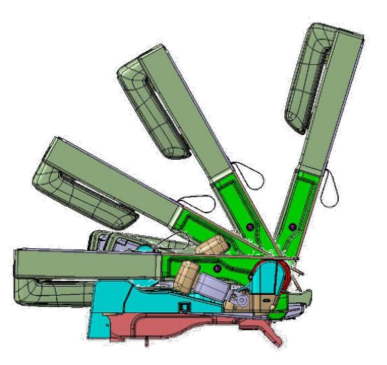
肩口のノブを片手で解除するだけで 座面が後方に入り込みながら、 背もたれが倒れることで、 ヘッドレストを外さなくても フルフラットな荷室を実現。
